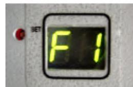
Pulse el botón SET durante 2 segundos para la velocidad del ventilador de vacío
